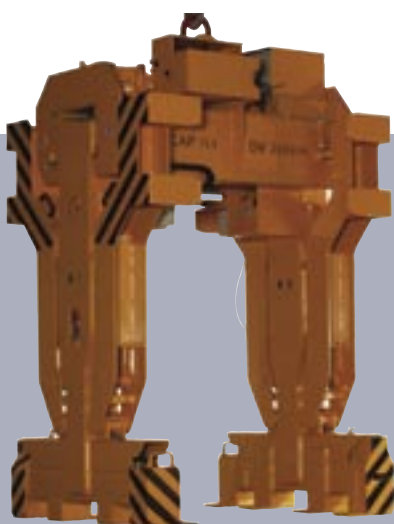
Elektromotorischer Teleskopblechpaketgreifer mit feststehenden mittigen Greiferfüßen, mit zusätzlichen manuell ausziehbaren Greiferfüßen und elektrohydraulisch ausschwenkbaren äußeren Greiferfüßen
