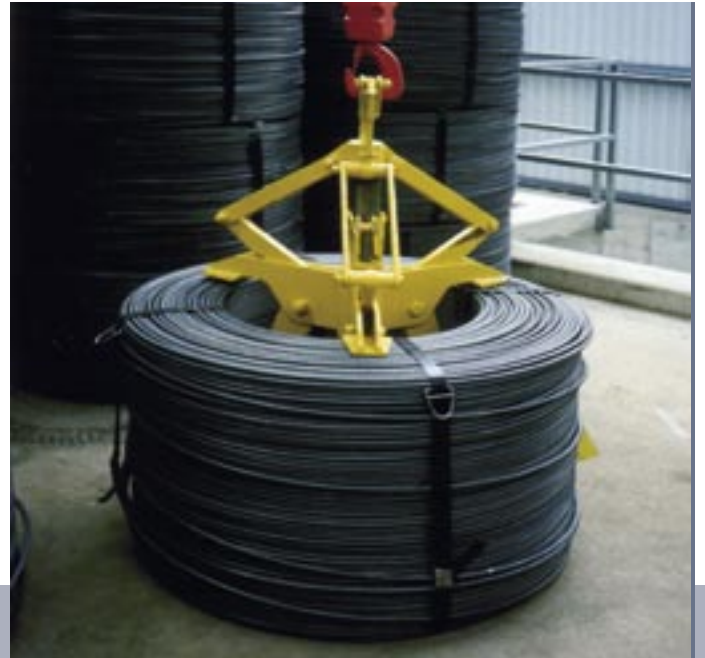
3-armige Drahtcoilinnenzange, Typ DCIZ-3-650, zum Greifen von abgebundenen Drahtcoils mit bis zu 5 t Eigengewicht
