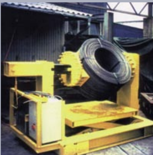
Elektromotorische Coilwendestation mit Wendeantrieb und Hubtisch
