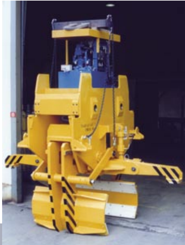
Elektrohydraulische Arbeitswalzen-transportzange mit Niederhaltefunktion für Baustücke
