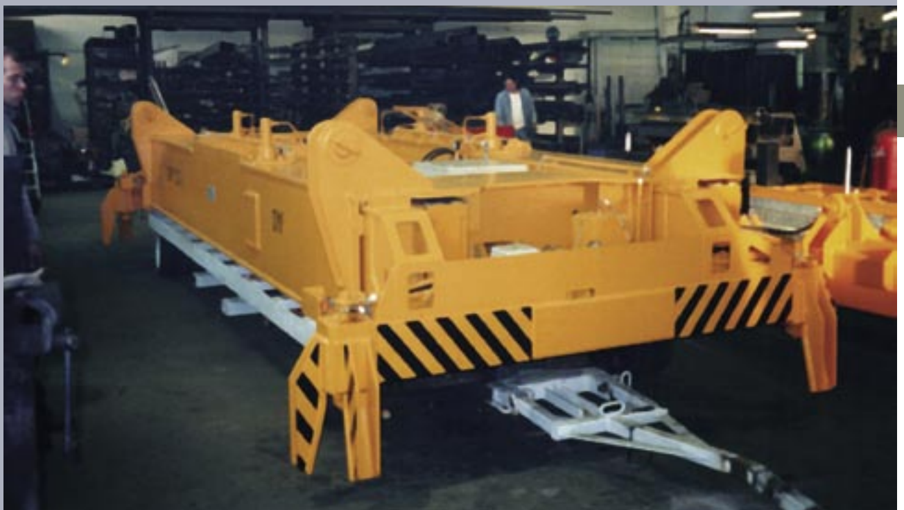
Elektrohydraulischer Containerspreader für 20' ISO-Container und Wechselaufbauten
