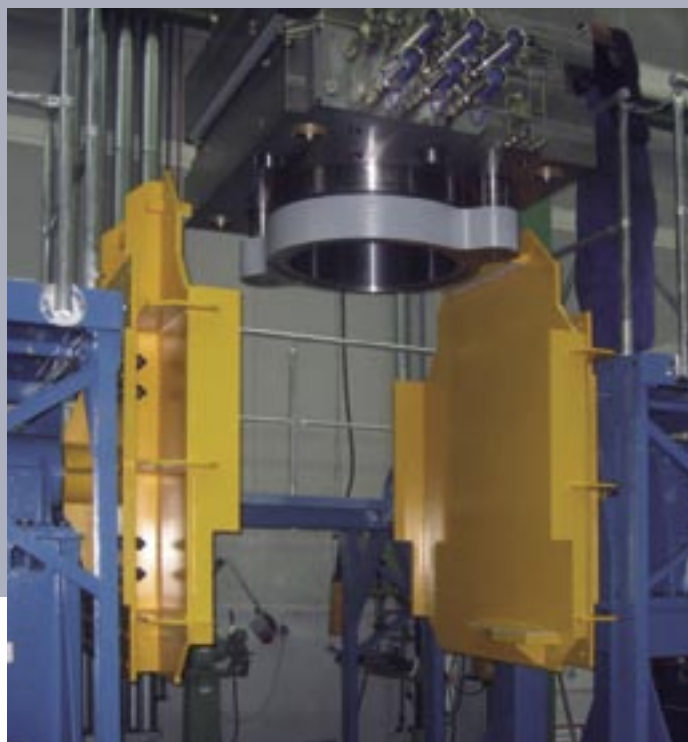
Elektrohydraulische Werkzeugwendevorrichtung für 20t stationäre Presswerkzeuge
