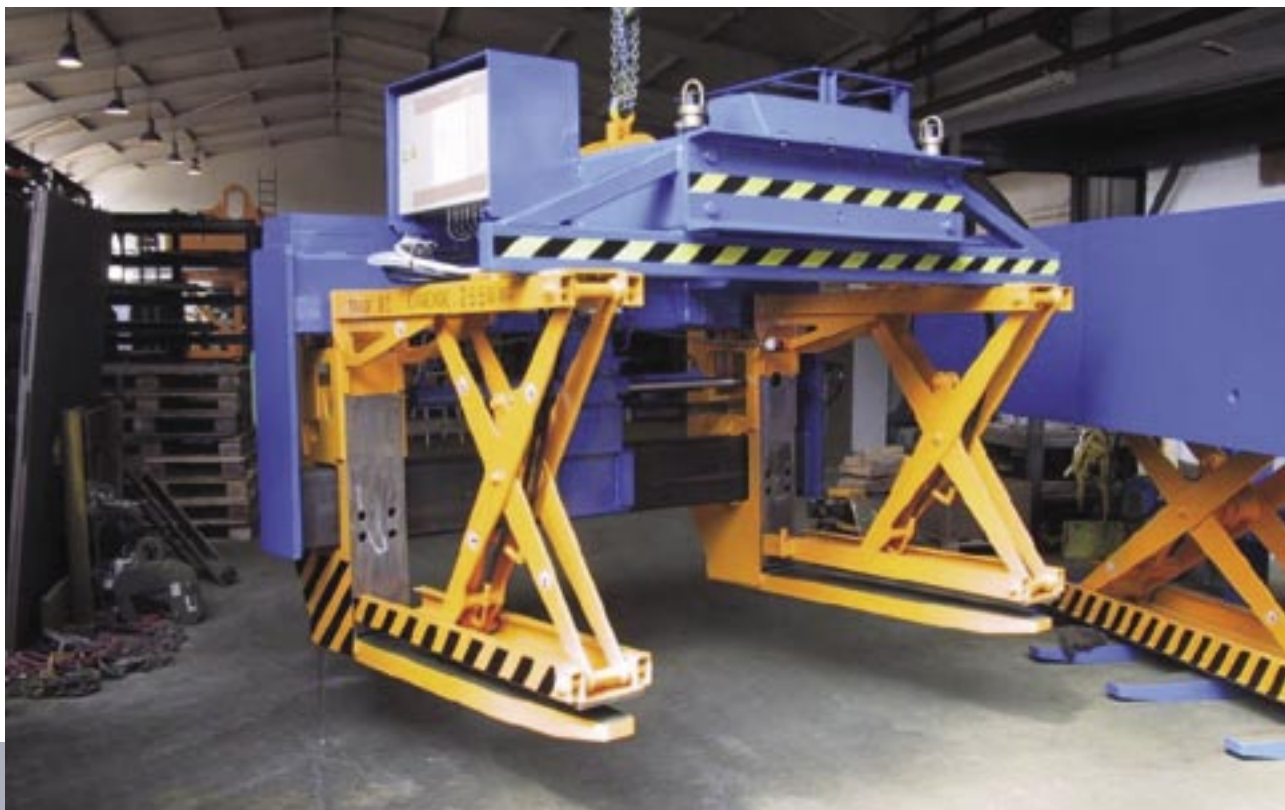
Elektrohydraulische Platinenladegabel mit Niederhaltefunktion und Greifweitenverstellung
