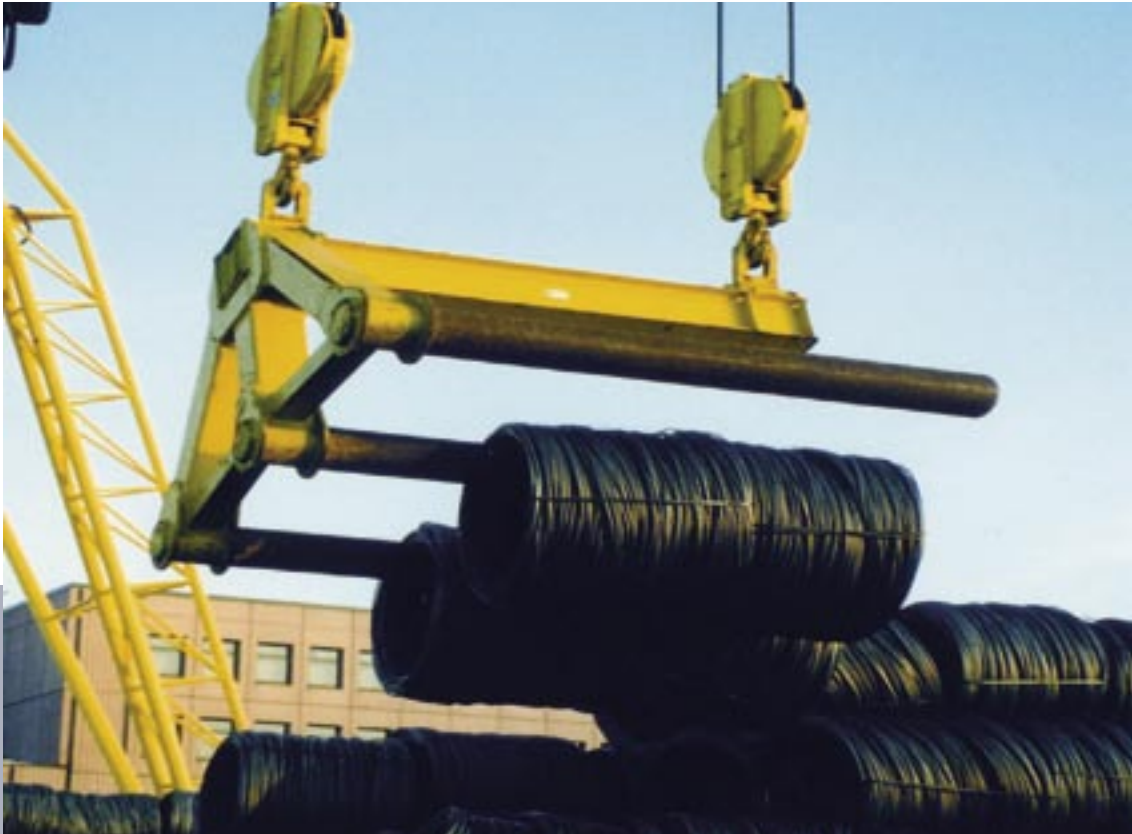
3-armiger C-Haken zur Aufnahme von Drahtcoils
