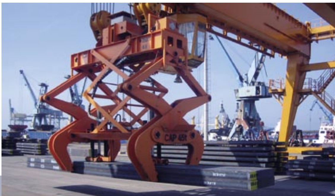
Elektrohydraulische Brammenzange mit Elektrohubzug und hydraulischer Tischhöhenverstellung, jedoch mit Zweipunktaufhängung
