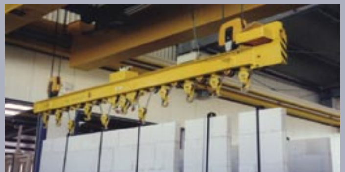
Ausgleichstraverse mit integriertem Elektrokettenzug zum Einkürzen der Ausgleichskette
