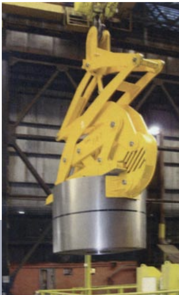
Einfachvertikalcoilzange in mechanischer Ausführung
