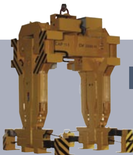
Elektromotorischer Teleskopblechpaketgreifer mit feststehenden mittigen Greiferfüßen, mit zusätzlichen manuell ausziehbaren Greiferfüßen und elektrohydraulisch ausschwenkbaren äußeren Greiferfüßen
