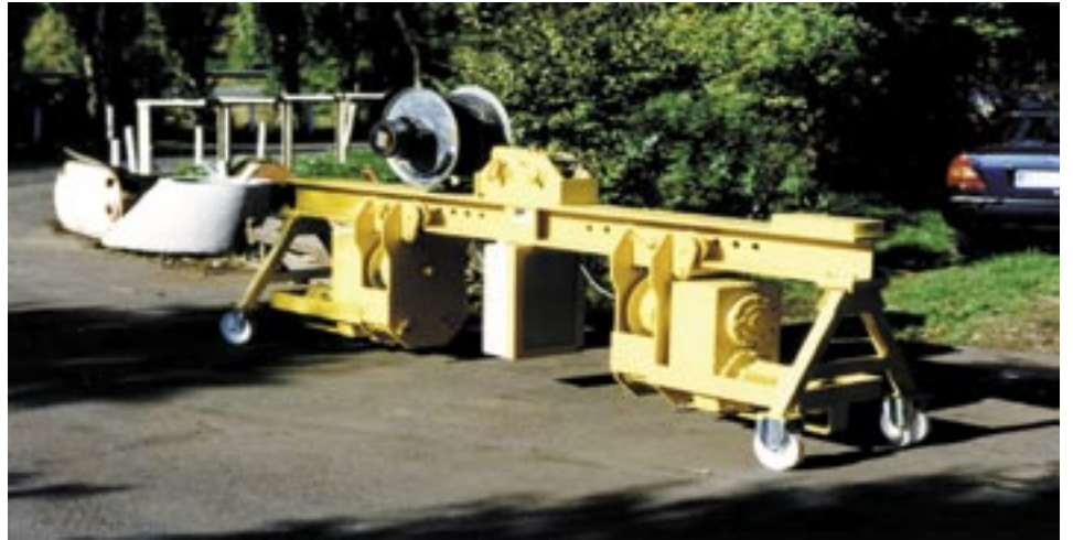
Elektromotorische Wendetraverse mit Verstellraster
