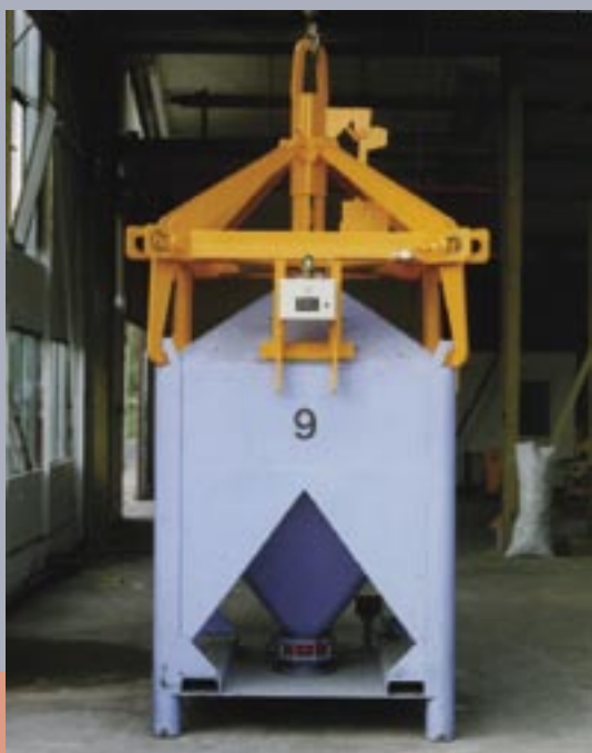
Gestellgreifer mit Schrittschaltwerk und elektronischer Überwachung der Schließung
