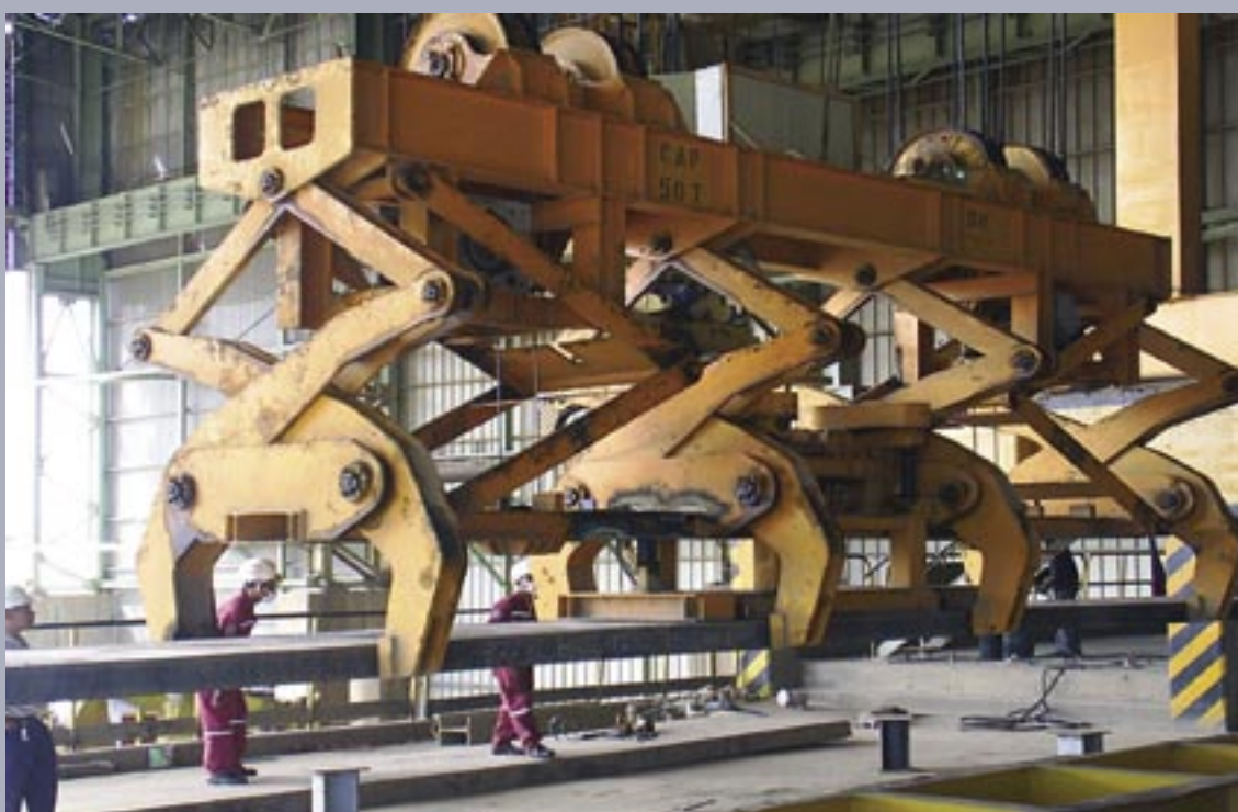
Elektromotorische Vierfachbrammenzange mit elektrischem Hubwerk und elektrischer Tischhöhenverstellung
