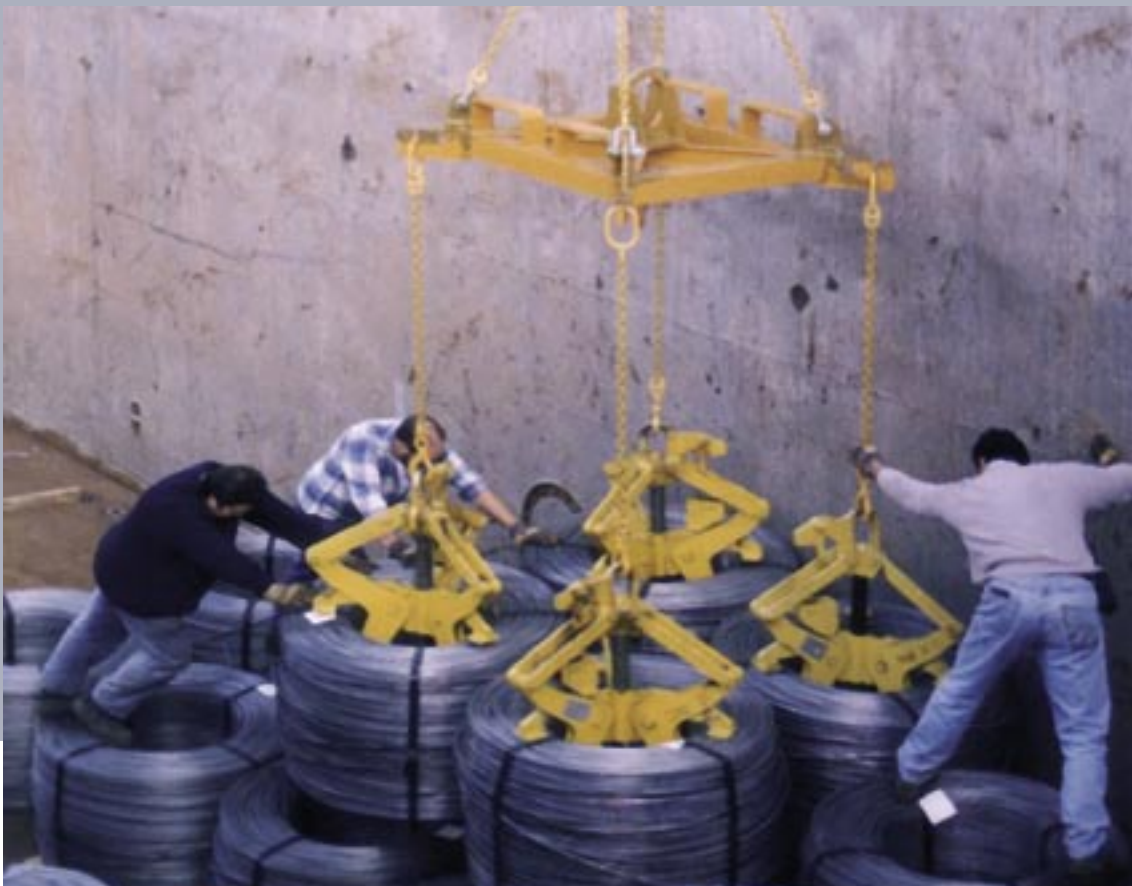
Drahtcoilinnenzange in 4-fach Kombination mit Adaptertraverse
