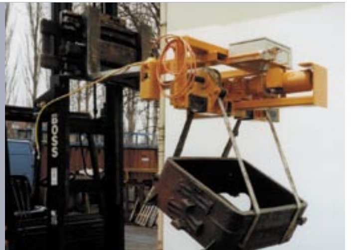
Wendetraverse als Stapleranbaugerät - Gleichstrom gespeist an der Anlasserbatterie
