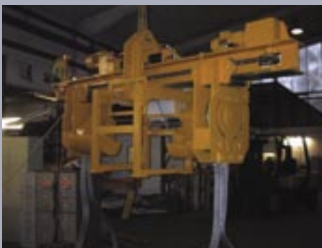
Wendetraverse mit Kettenverstellung
