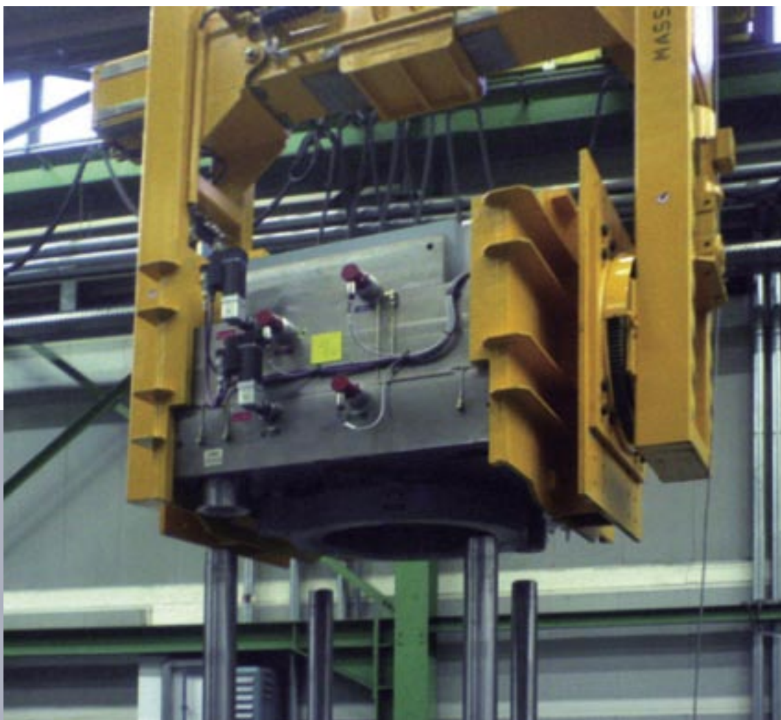
Elektromotorische Werkzeugwendevorrichtung zum Drehen von Presswerkzeugen
