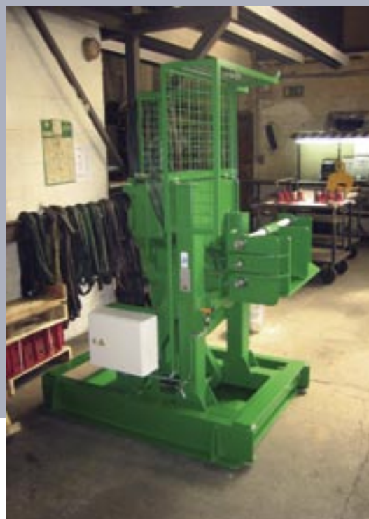
Elektromotorische Trägerwendevorrichtung für Walzprofile
