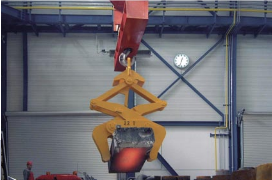
Mechanische Blockzange für Heißbetrieb
