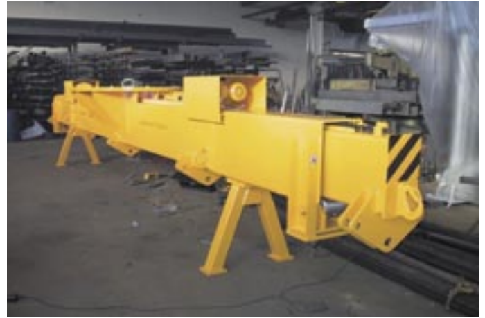
Elektromotorische Teleskoptraverse mit oben liegender Zahnstange und 2 Antriebseinheiten
