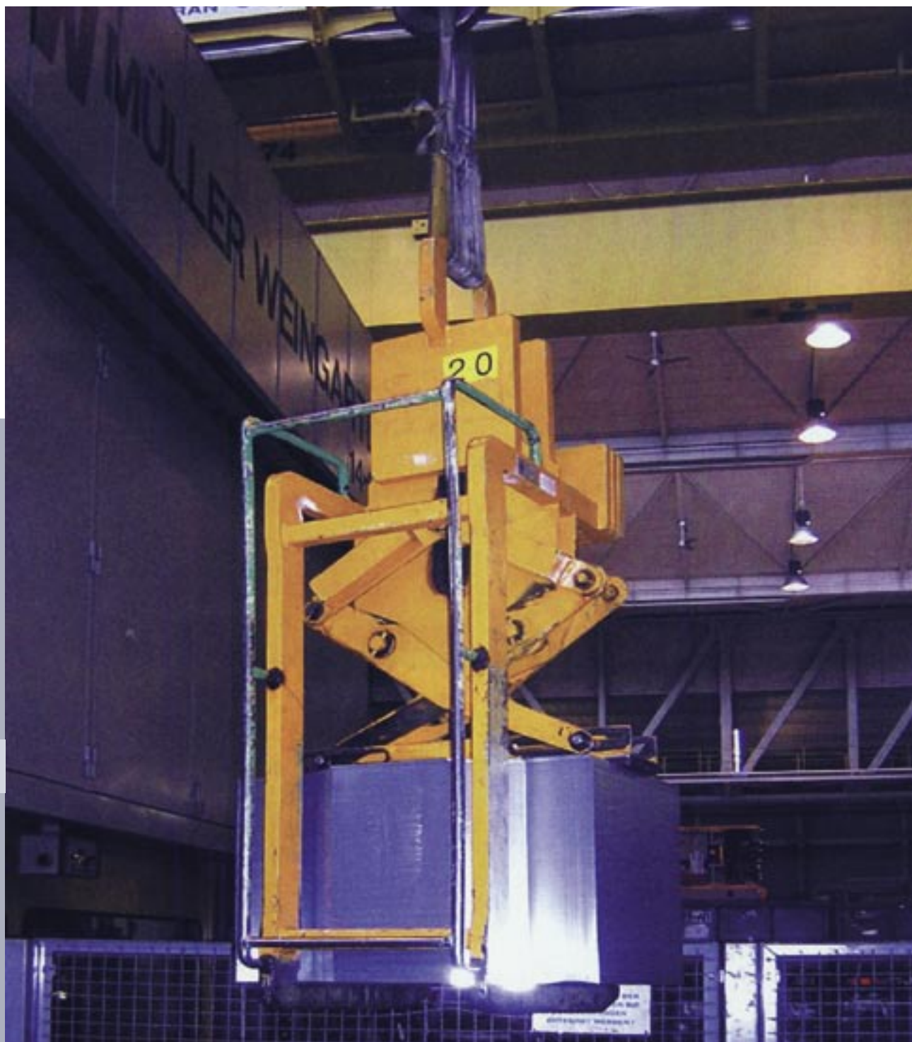
Platinenladegabel mit mechanischer Niederhaltefunktion
