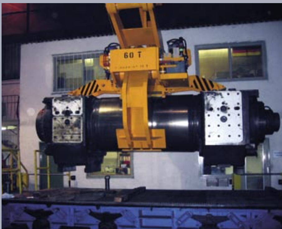
Mechanische Walzen-Transportzange mit elektrohydraulischer Niederhaltefunktion zum Sichern der Baustücke gegen Torsion
