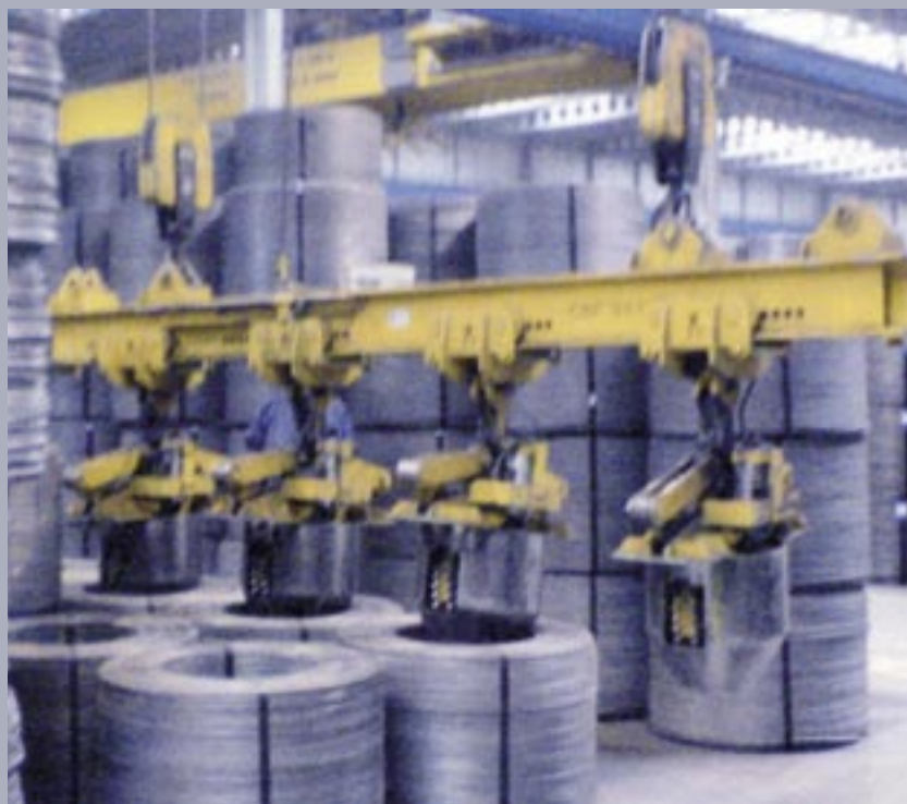
Sondertraverse mit 4-facher Anordnung von Drahtcoilinnenzangen und elektromagnetischer Entriegelung, Greifweite individuell über Rollfahrwerk und Steckbolzen verstellbar.
