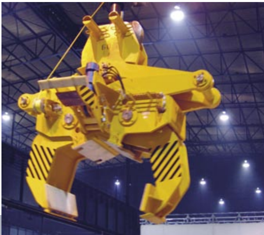
Mechanische Walzen-Transportzange mit elektrohydraulischer Niederhaltefunktion zum Sichern der Baustücke gegen Torsion
