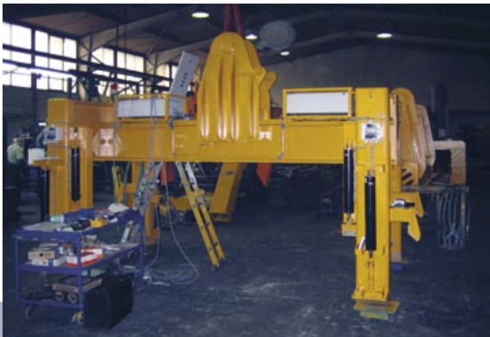
Elektromotorische Stützwälzentransporttraverse zum Greifen von Stützwälzen mit Baustücken
