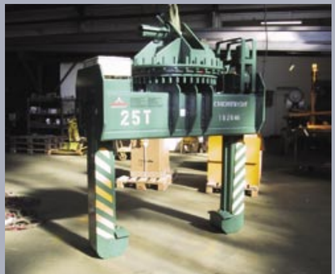
Teleskopcoilgreifer mit Drehwerk
