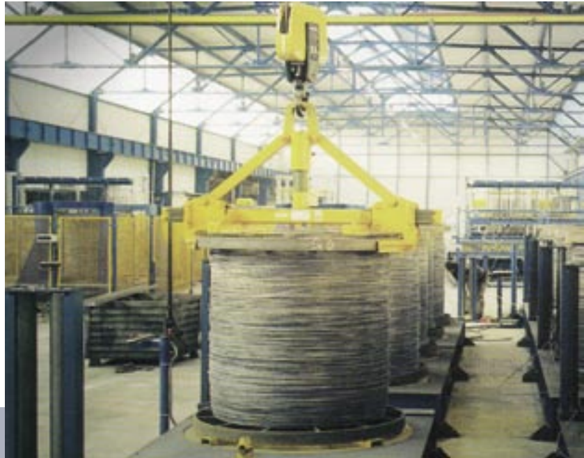
Spulenzange für vertikalen Transport
