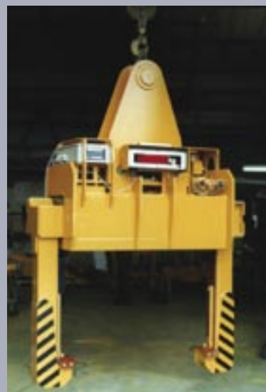
Teleskopcoilgreifer mit integrierter Wägeeinrichtung
