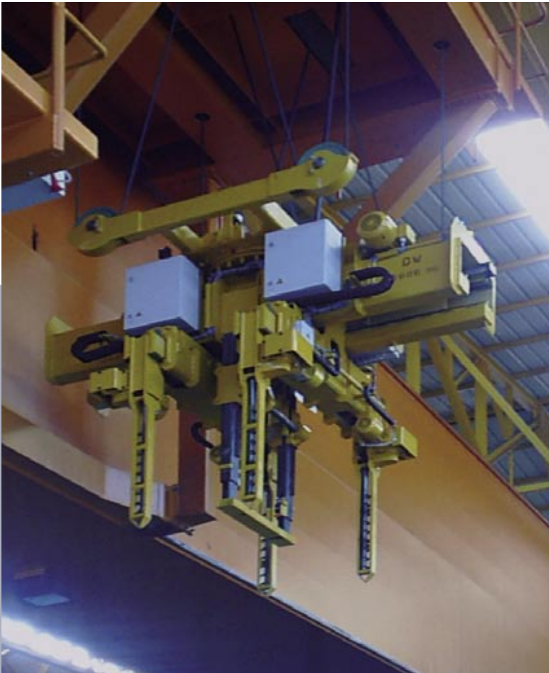
Elektromotorischer Baustahlmattengreifer, innen greifend, mit Drehwerk und Seilrollenaufhängung, mit längs und quer verstellbarer Greifweitenvoreinstellung und drehbaren Greiffüßen, mit elektromotorischer Innenhöhenverstellung für unterschiedliche Mattenstapelhöhen
