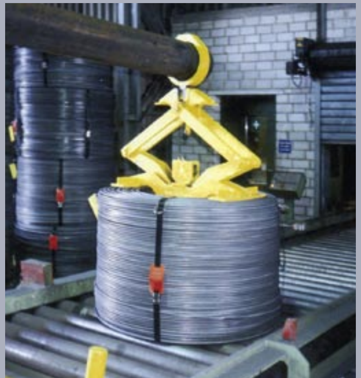
2-armige Drahtcoilinnenzange, Typ DCIZ-2-650, in Ausführung mit runder Staplerdornaufhängung
