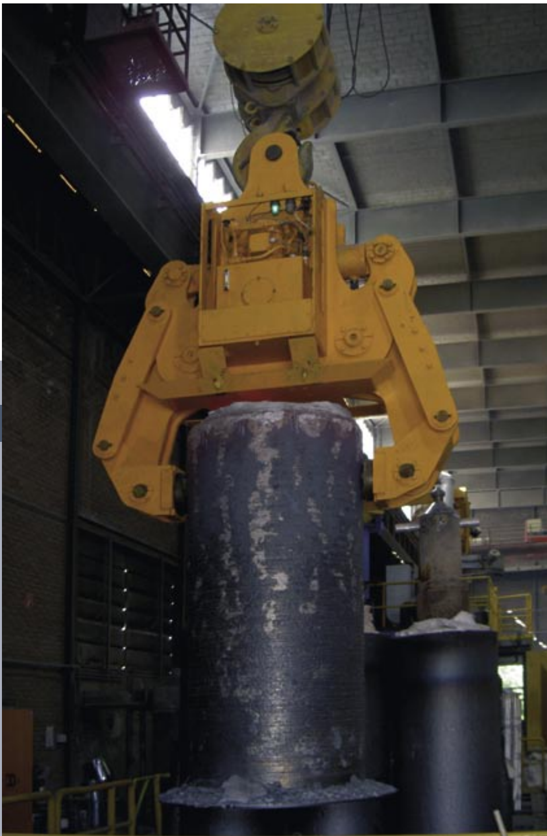
Elektrohydraulische Blockzange für Rundblocktransport mit drehbaren Backen, geeignet für Vertikaltransport und zum Umlegen von Blöcken im Heißbetrieb
