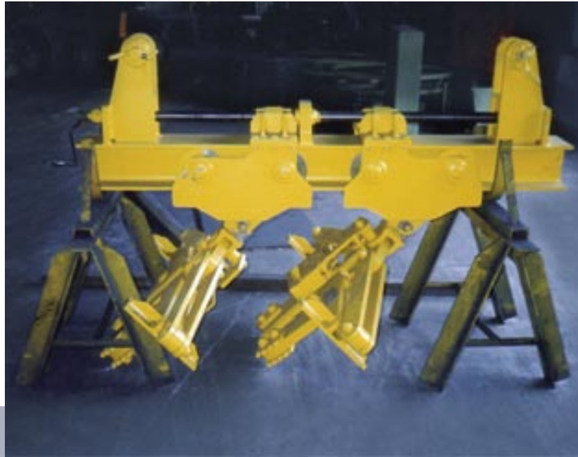
Sondertraverse mit angeflanschten Drahtcoilinnenzangen in Hüttenwerksausführung, Greifweite manuell über Spindel und Handkurbel individuell zu verstellen
