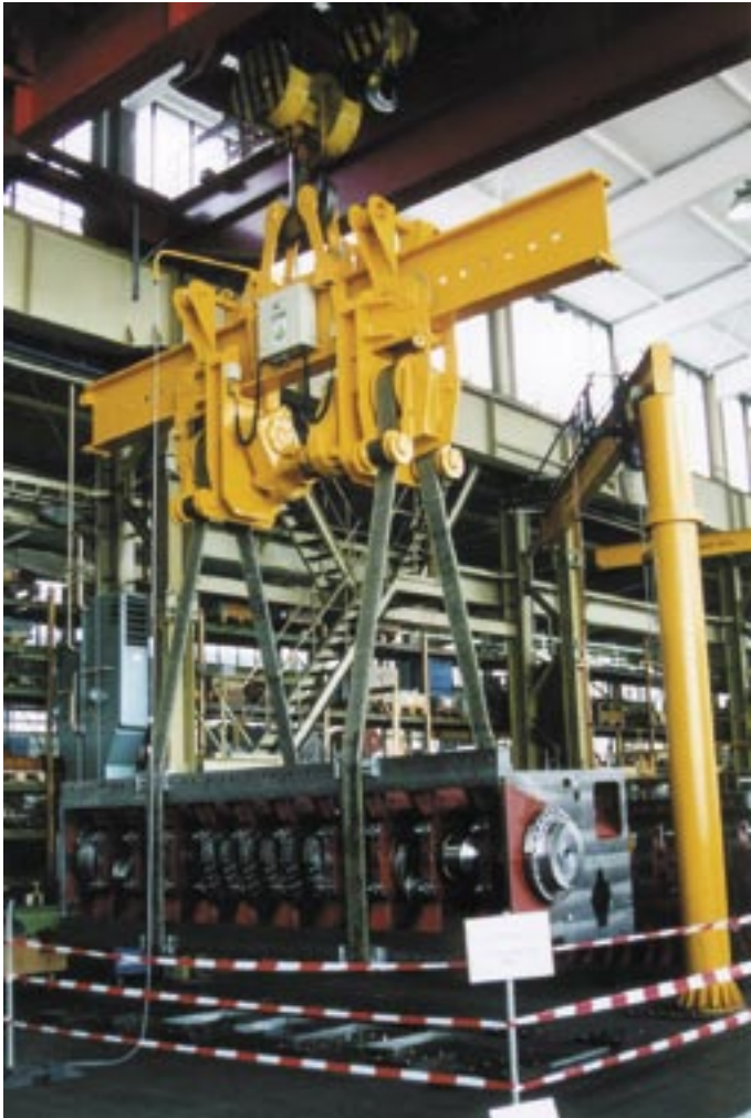
Elektromotorische Wendetraverse mit Rasterverstellung
