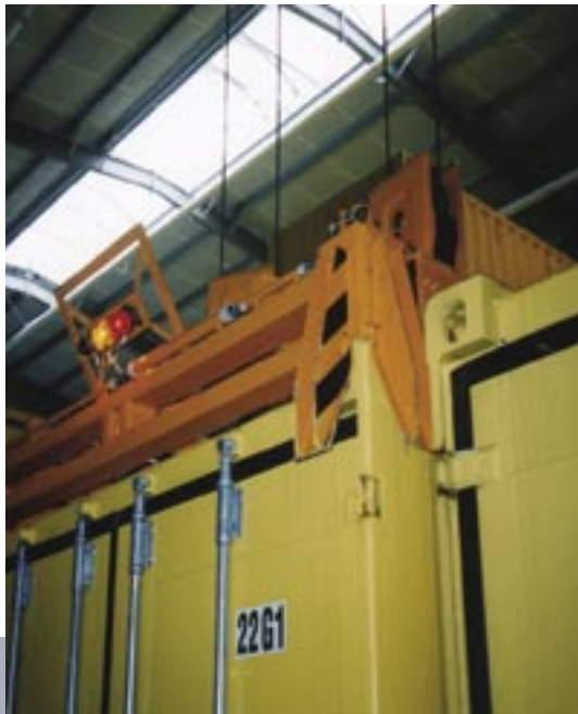
Elektrohydraulischer Containerspreader für 20' ISO-Container und Wechselaufbauten
