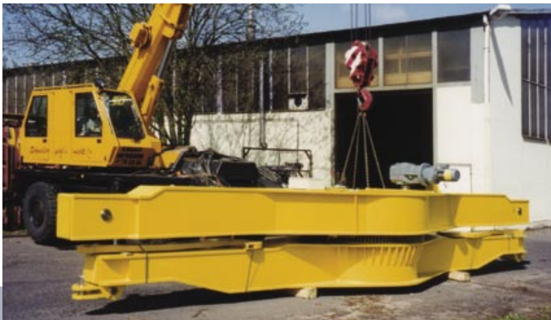
Tambourtraverse mit elektrischem Drehwerk (Darstellung ohne Haken)
