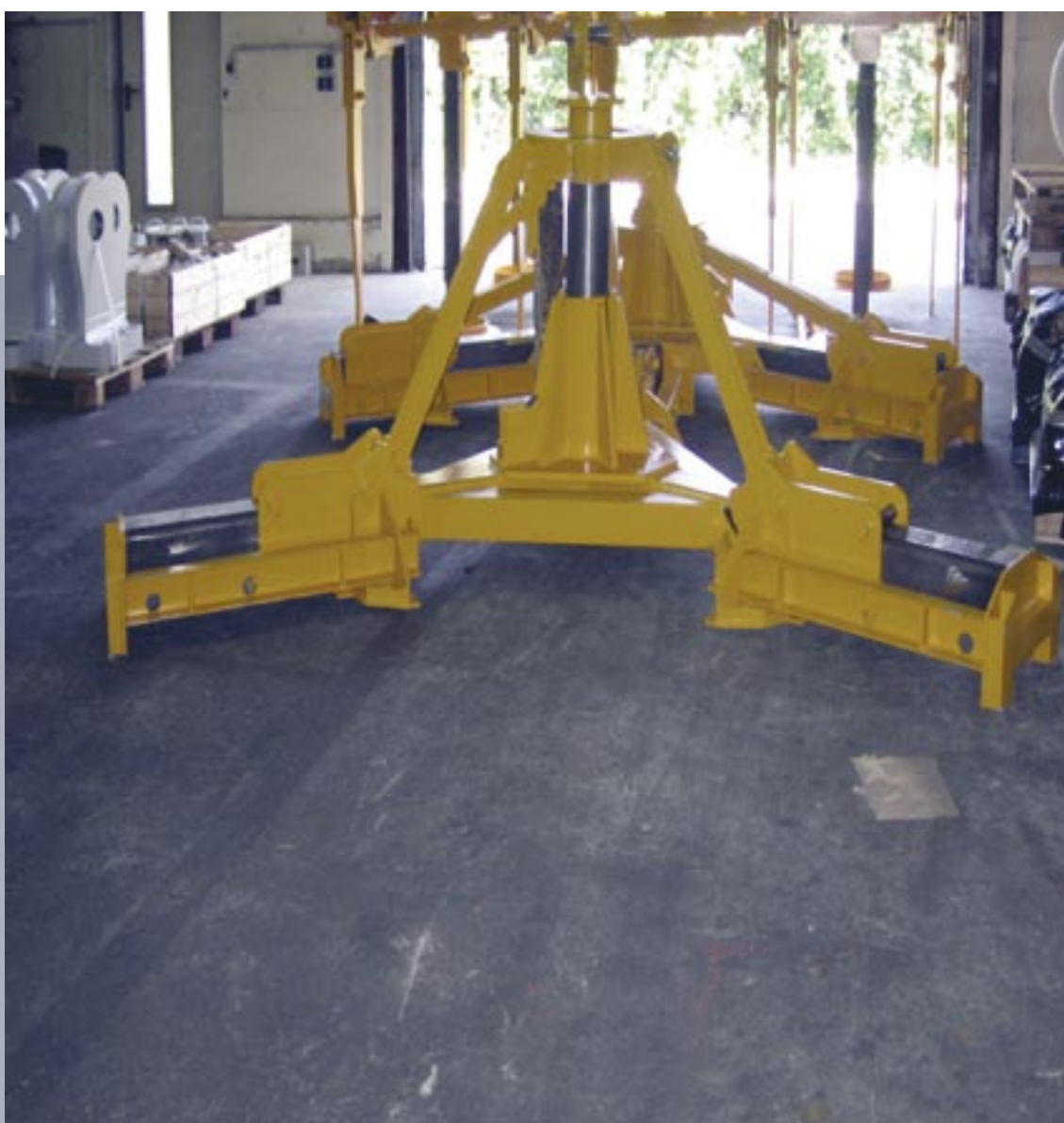
Mechanische Konvektorschleibenzange zum Greifen von Konvektorschleiben in der Glüherei.
