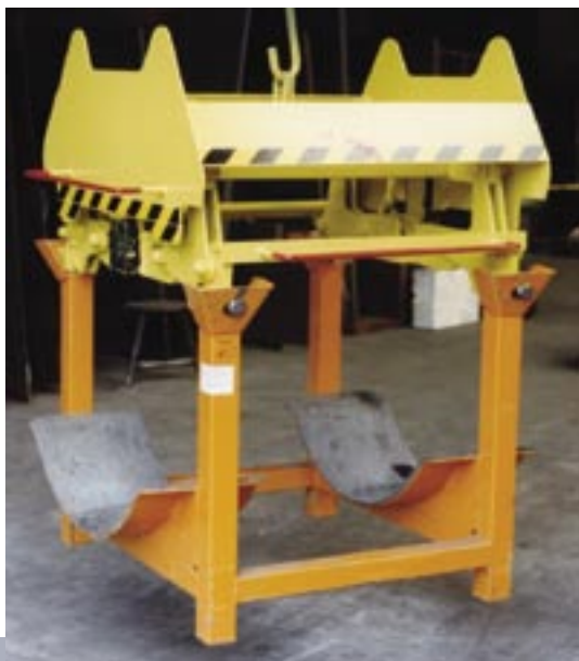
Gestellgreifer mit manueller Aufsetzautomatik
