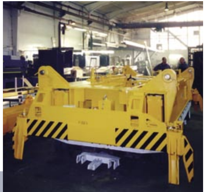
Containerspreader elektrohydraulisch teleskopierbar von 20' bis 40'
