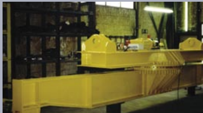
Elektromotorische Drehtraverse für 2-Kranbetrieb
