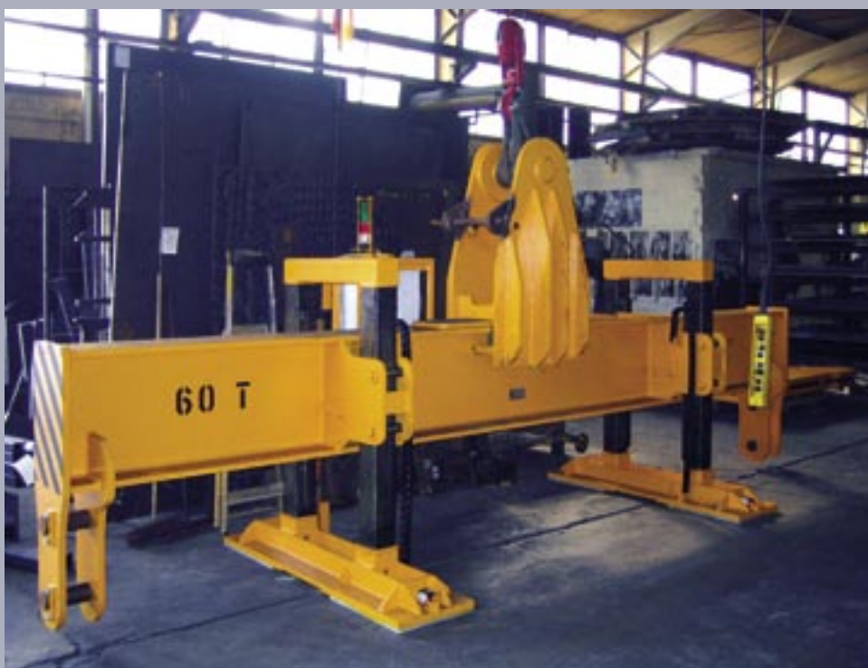
Elektromotorische Stützwälzentransporttraverse mit verfahrbaren Greifzapfen für die Baustücke
