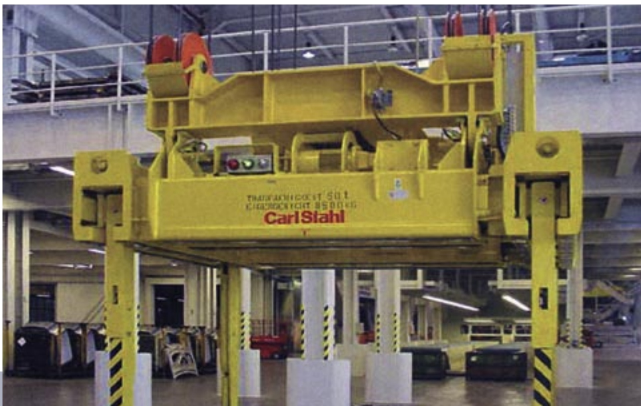
Elektromotorischer Werkzeuggreifer für die Automobilindustrie
