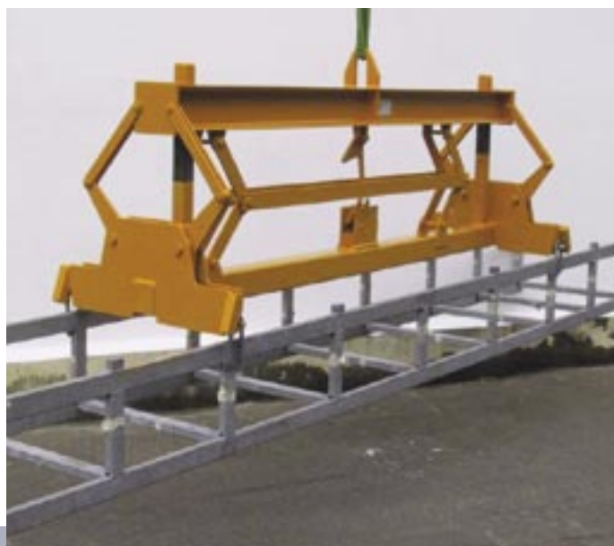
Gestellgreifer mit manueller Aufsetzautomatik
