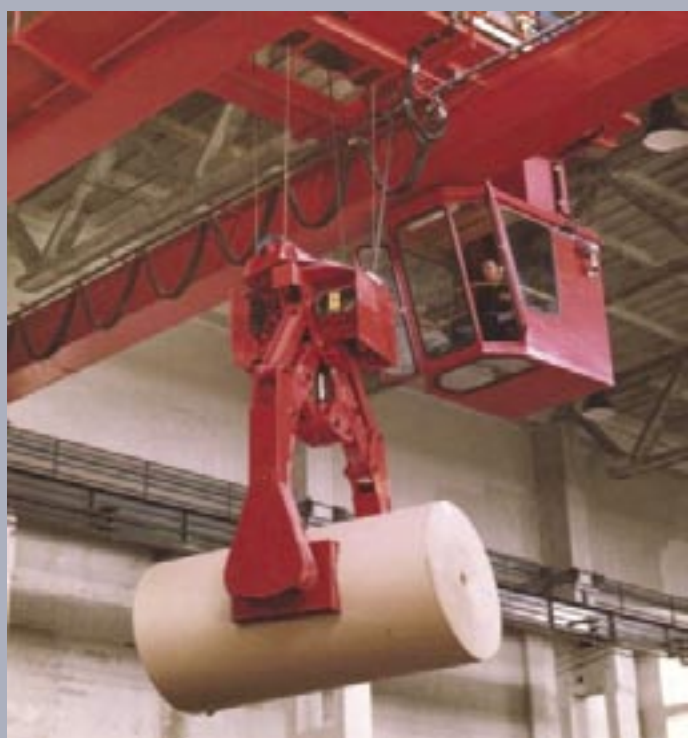
Elektrohydraulischer Papierrollengreifer mit 90 Grad Schwenkwerk
