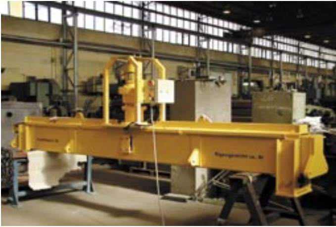
Elektromotorische Teleskoptraverse mit Zahnstangenantrieb
