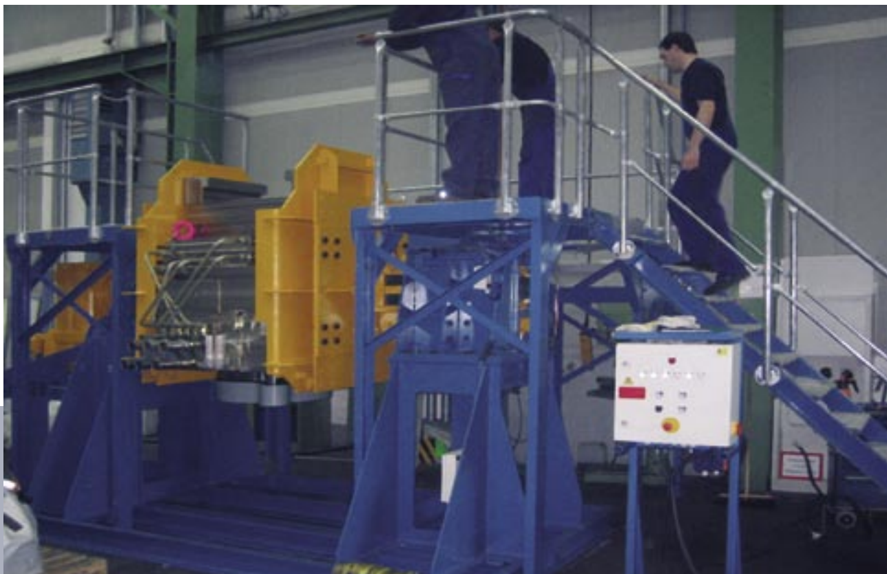
Elektrohydraulische Werkzeugwendevorrichtung für 20t stationäre Presswerkzeuge
