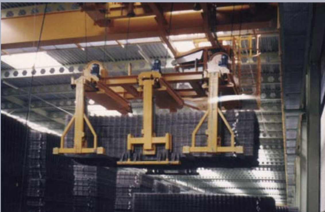
Baustahlmattengreifer mit individueller Querverstellung
